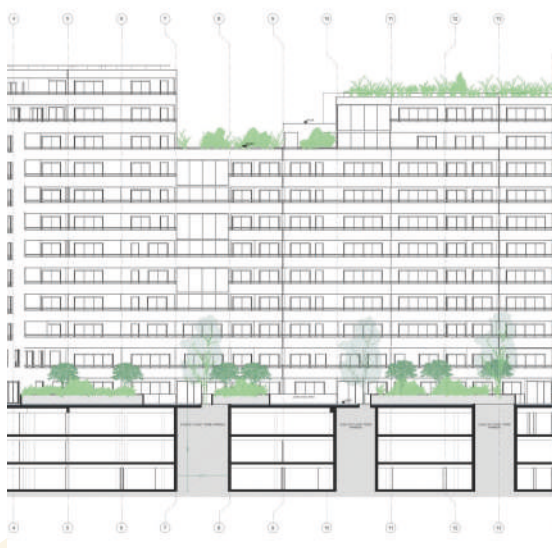
Fosses d'arbres de pleine terre ©Adret/BDM
